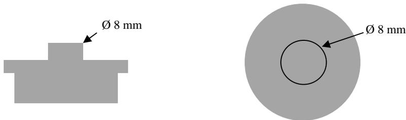
**Abbildung 4**, schematische Darstellung des PMMA-Reibkörpers.
